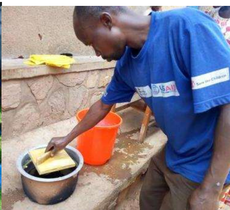
Figures 25 et 26 : La planche carrée est trempée dans l'eau savonneuse puis dans la casserole de cire fondue en alternance (2 à 3 fois) (ARDI-2018).
