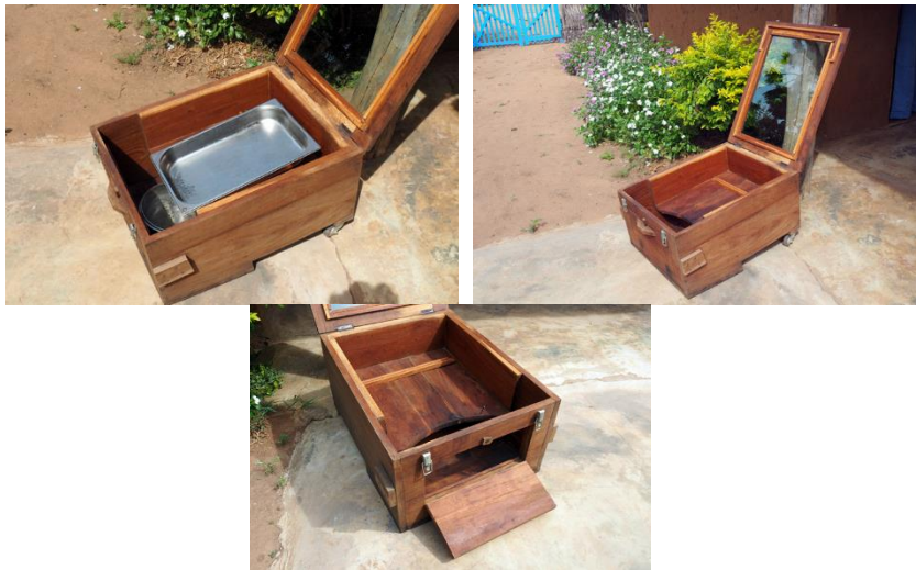
Images 17 : Etat g n ral du c erificateur apr s 5 ann es d'utilisation et de bon entretien. Claire Cl ment - 2019
