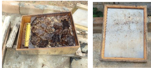
Image 15. Cérificateur solaire en bois en 2 ème année de test : chargé de rayon noircis dont la cire s'est écoulée dans le bac de récolte. A droit, le couvercle avec la vitre en plexiglas.
