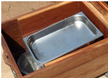
Image 8 et 9 : Choix du matériel pour le plateau incliné sur lequel les rayons de cire sont déposés. A gauche : un bac en inox percé de petits trous à une extrémité ; à droite une tôle ondulée.
