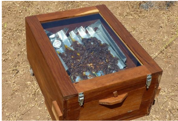
Image 4. Cérificateur solaire en fonctionnement : fonte de rayons noircis
