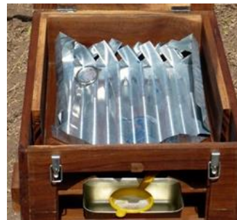
Image 8 et 9 : Choix du matériel pour le plateau incliné sur lequel les rayons de cire sont déposés. A gauche : un bac en inox percé de petits trous à une extrémité ; à droite une tôle ondulée.
