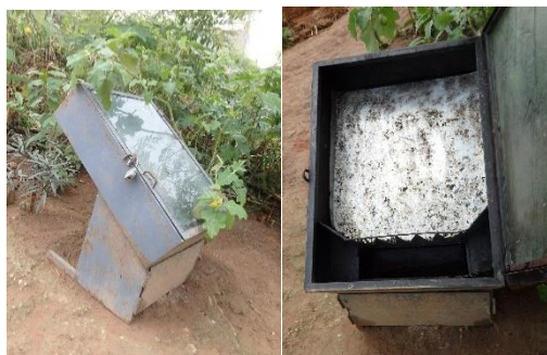
Image 16. Cérificateur solaire en acier en 2ème année de test : il est rouillé et n'est plus utilisé
