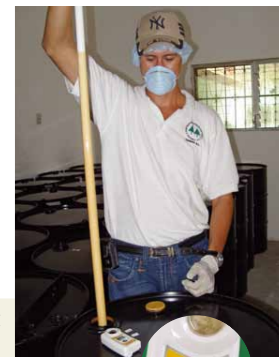
Esvin Monroy Estrada prélevant du miel chez Coadap R.L. (Santa Elena, Péten, Guatemala, 29/7/09). Réfractomètre digital, appareil mesurant le taux d'humidité du miel.
