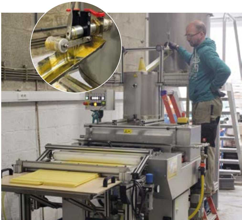
De la cuve à la feuille de cire. Détail de la cire coulée.
